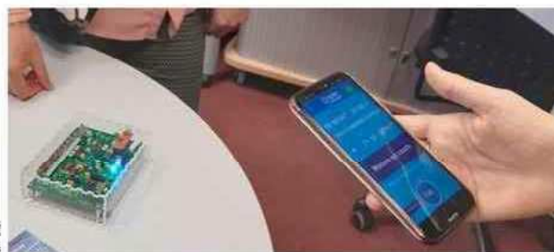
Un appareil de mesure en kit et une appli sur votre smartphone vous permettent de mesurer la radioactivité.
