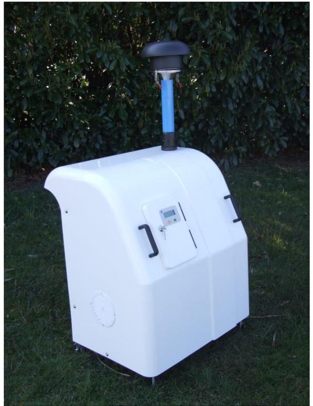
**EAS 70K** est conforme à la norme NF-M-60-760 : prélèvement d'aérosols en vue de la mesure de la radioactivité dans l'environnement.
