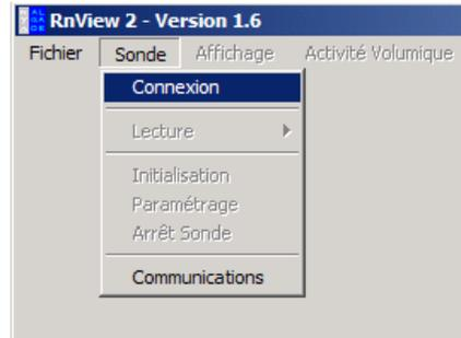
Connexion → étape préalable pour accéder aux fonctions de la sonde quand la liaison est par GSM.
